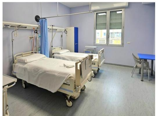
Per le finiture dell'area sono stati scelti, per i pavimenti, teli in PVC facilmente sanificabili con colorazione di media tonalità, mentre le pareti sono rivestite con teli vinilici di colorazione più chiara, in modo da consentire le condizioni ottimali di visione del Paziente e di relax per la vista degli Operatori.
